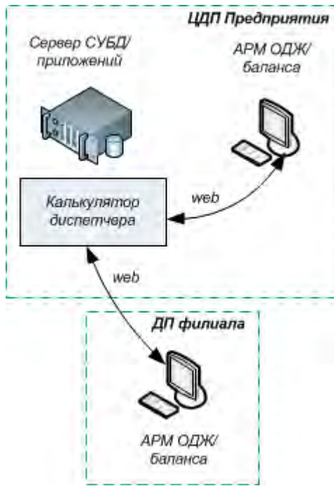
Рис. 2.11 Калькулятор диспетчера. Распределение клиентского ПО по АРМ
