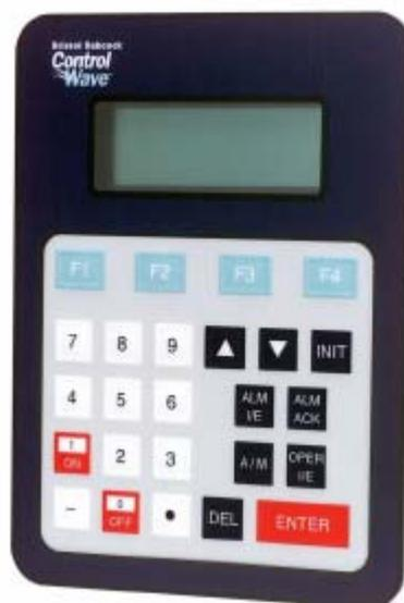
Вверху показан жидкокристаллический дисплей с 25-кнопочной клавишной панелью. Версия двухкнопочного дисплея аналогичная, но включает в себя только две кнопки вперед-назад для просмотра списков.
