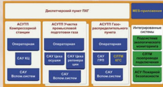
Типовая структурная схема ИУС СПХГ
