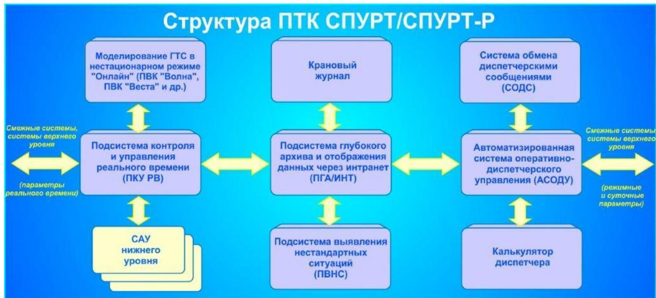
Рис. 2.1 Структура ПК «СПУРТ-Р»
