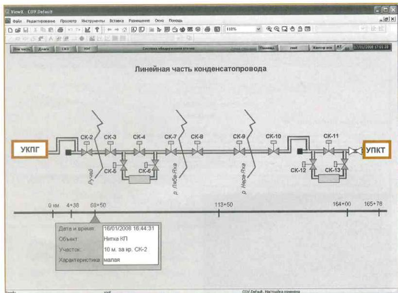
Рис. 2. СПУРТ. Система обнаружения утечек
